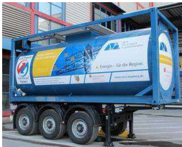
Abb. 90: Beispiel: Mobiler Latentwärmespeicher (AVA Augsburg); Quelle: AVA GmbH
