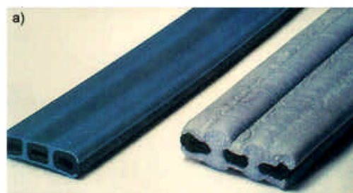
Abbildung 47: Hydrotite-Dichtungsprofile vor und nach dem Quellvorgang
