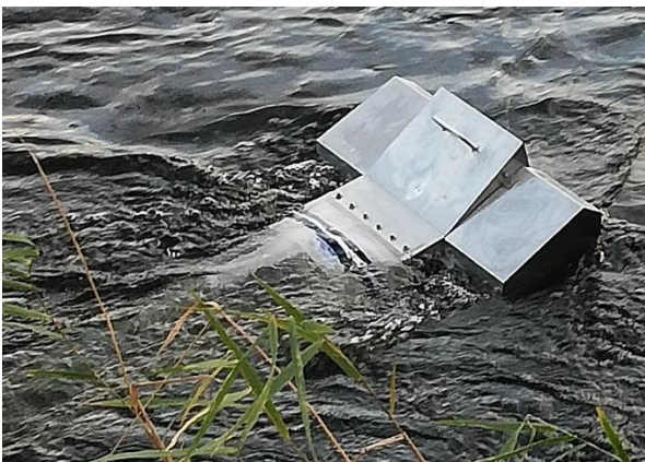
Abbildung 83: „Mantarochen“ – Werkzeug zur Probenahme von Mikroplastik (Quelle: TLUBN)
