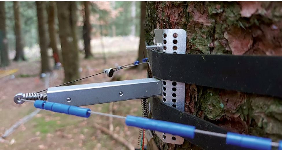
Abbildung 7: Aufbau einer Haupt-/Waldmessstation
